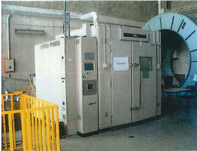
図2 試験室 (エスペック (株) 製 ビルドインチャンバ TBE-2HW5G3A)
