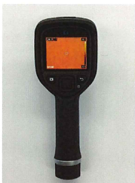
図 1 非接触温度計 (FLIR 製 E4)
