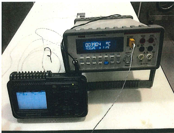
図3 デジタルマルチメーター (ケースレー製 2110 : 右) およびデータロガー (グラフテック (株) 製 GL200A : 左)
