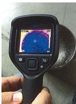
図 3 氷水の非接触温度測定
